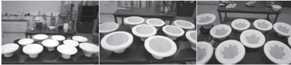
1. 円錐石膏型 2. 円錐鑄込み 3. 円錐脱型後測カット
