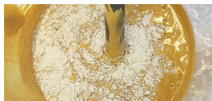
図8 廃棄陶磁器粉末を泥漿に混練する
