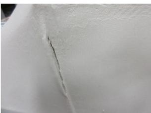
図12 長時間放置後の亀裂
