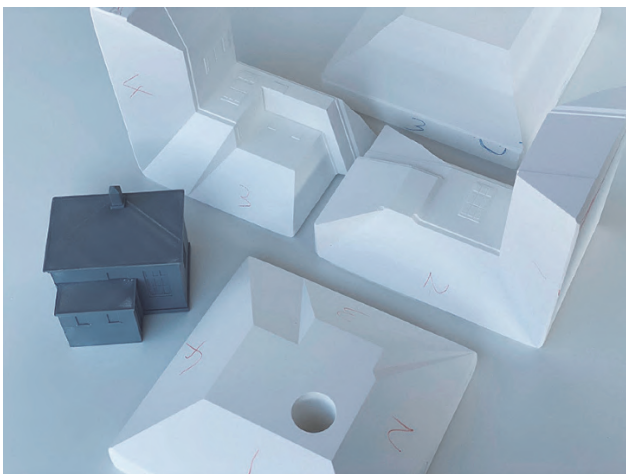
▲ 3D プリンターによる原型 [モデル 2B278] と CAM による使用型の切削 : PLA樹脂 / 0.05mm / 37:48min / 114.9g / 15%
