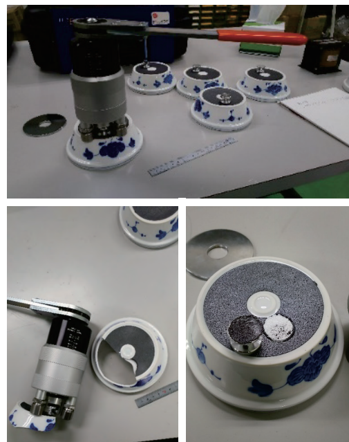
図4 付着性試験を行った後のサンプル 左：開発シール材、右：既存の銀厚膜の製品
