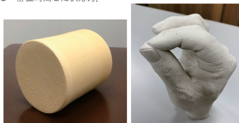
図3 自硬性鑄込みによる成形体（φ90mm円柱）と焼成品（手）。
