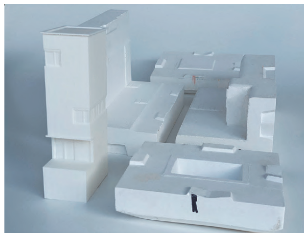
▲ 3Dプリンターによる原形【モデル 15B357】とそこから作成した使用型(PLA樹脂 / 0.05mm / 107:34min / 295.4g / 15%)
