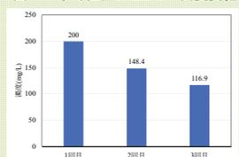
図-9 平均粒径1.4mmでの濁度変化
