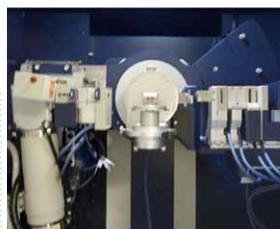
X線回折による残留応力測定
